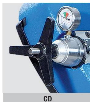
Ukazatel napnutí pilového pásu
