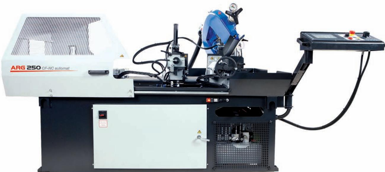
**Kryt** – jednoduše posuvný bezpečnostní kryt umožňuje snadný přístup ke svěrákům.
