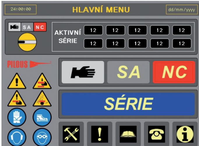
Hlavní menu umožňuje nastavení 3 základních režimů: NC – plně automatický, S.A. – poloautomatický nebo ruční ovládání pro dělení jednotlivých kusů (nezávislé ovládání pohybů stroje).
