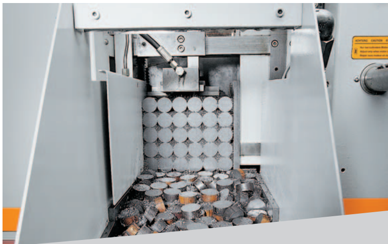
Motorisch angetriebener Rütteltisch mit Spüleinrichtung für weitgehend spannfreie Abschnitte (Option).
