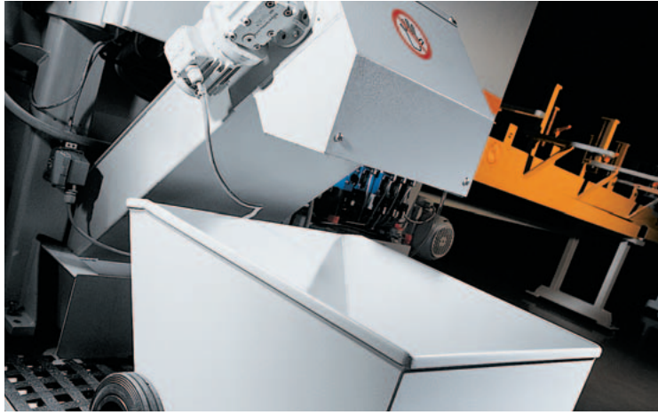
Der hohe Auswurf des Späneförderers (620 mm; optional 1.100 mm) spart Kühlmittel.
