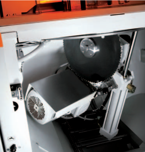
Großzügiger Zugang für einfachen Sägeblattwechsel.
