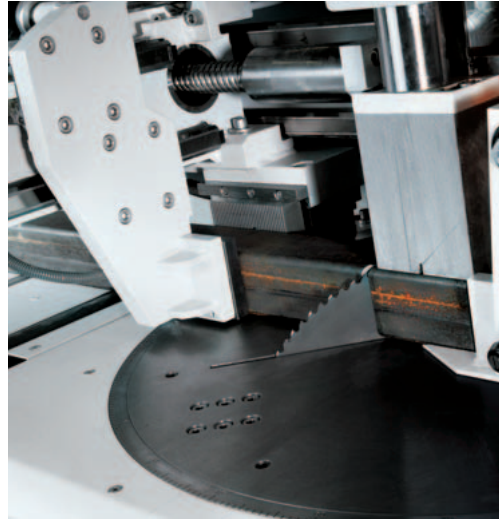
KASTOflex A: Vertikalspannstock und Materialvorschubeinheit.
