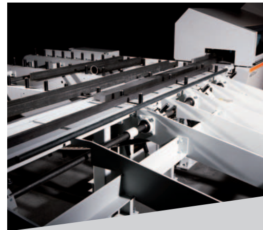
Universalmagazin für KASTOflex F mit Rücklagerpolder.
